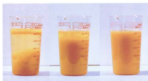
膠液：(左) 水1000ccに対し膠70gを入れ、(中) 一晩放置して膨潤、(右) 湯煎で溶かした状態。
