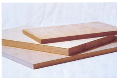
板の種類：上からシナ・ベニヤ、ランバー・コア・ボード、MDF。
