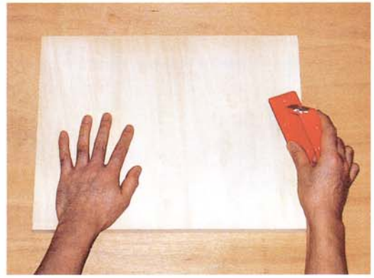
〔図2〕パネルの角にヤスリをかける。
